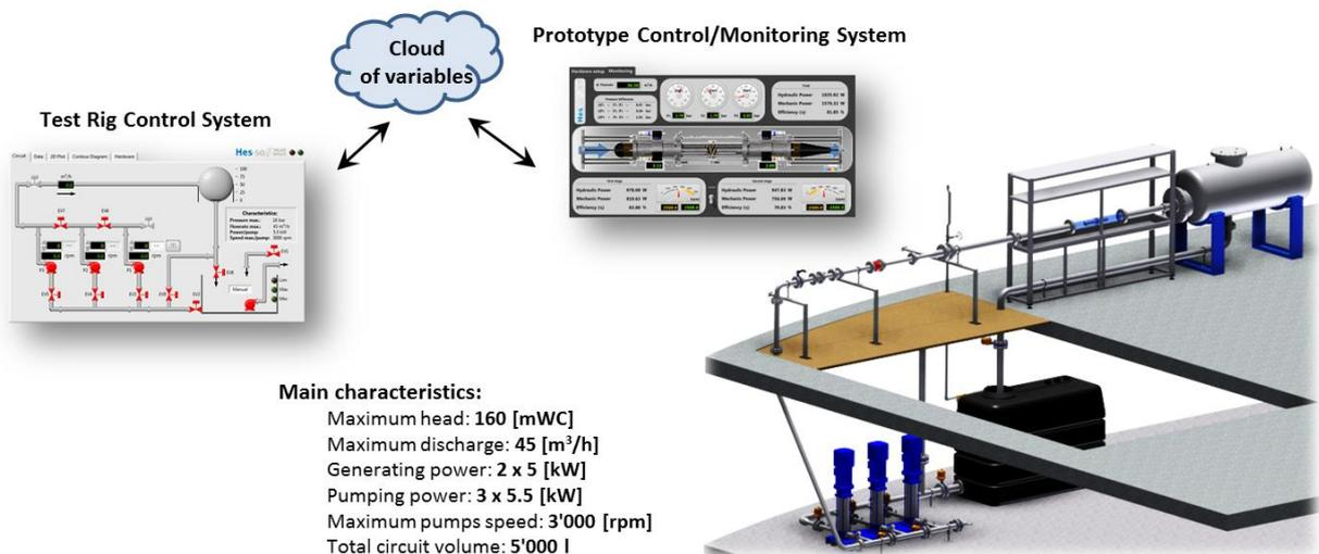
**Hydraulic test rig of the HES-SO Valais // Wallis - Sion**
